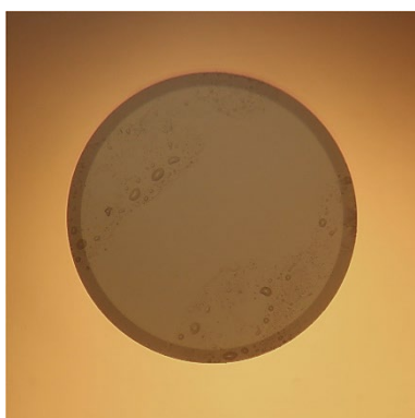
c. Connecteur free-standing contaminé
